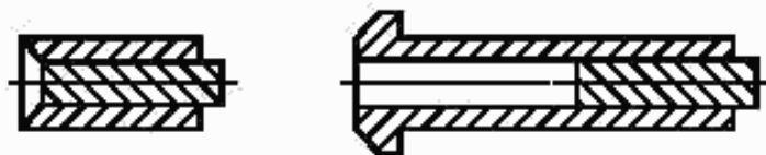
Рисунок А.2 — Заготовка для проверки силы удержания износостойкого элемента в корпусе шипа
